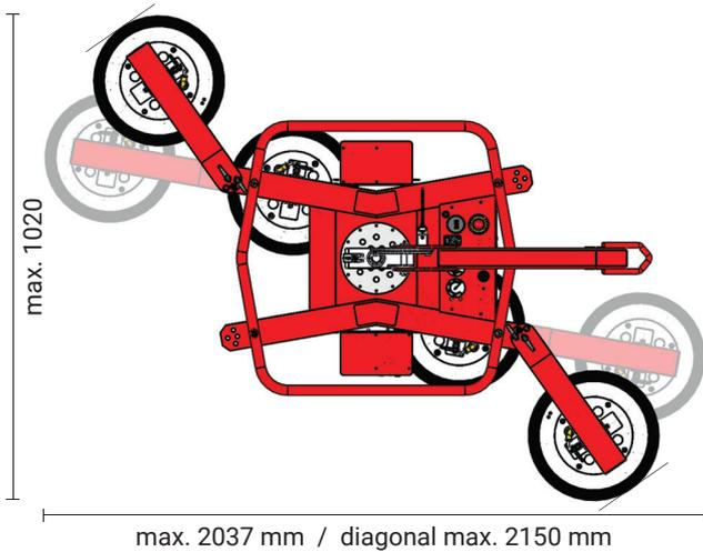
**Optionale-Erweiterung:** Erweiterung mit 4 Zusatzsaugplatten und 4 schwenkbaren Verlängerungsarmen
